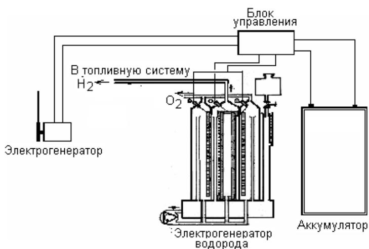
**Рис. 6.** Схема подключения электрогенератора водорода к системе электропитания и к топливному коллектору автомобиля
