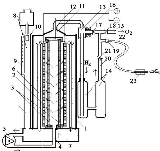
**Рис. 7.** Водородный реактор для газовой резки и сварки металлов [18]. Обозначения – по тексту
