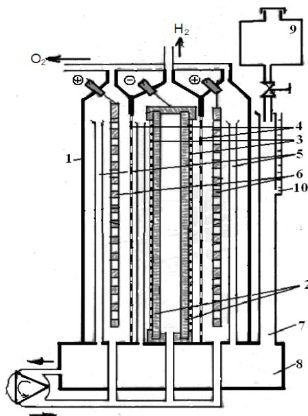
**Рис.5.** Электролизер для электролитического получения водорода с катодами из УВМ с Ni-Re модифицированной поверхностью: 1 – корпус; 2 – спаренные катоды; 3 – прижимные сетки; 4 – диафрагма; 5 - отводящие патрубки; 6 – перфорированные аноды; 7 - дозирующий трубопровод; 8 – рециркуляционная емкость; 9 - питательная емкость; 10 - уровнемер [15]
