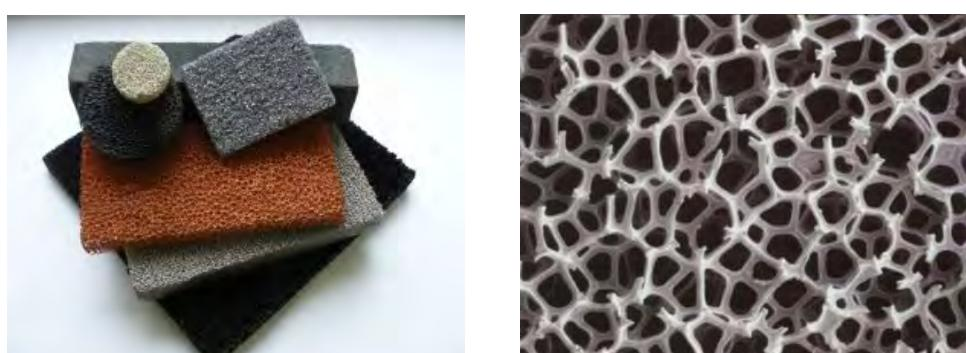
**Рис.3.** Внешний вид пенометаллов (А) и их ячеистая структура (Б)
