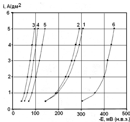
**Рис.2.** Стационарные поляризационные кривые, характеризующие процесс выделения водорода в 1 М растворе H<sub>2</sub>SO<sub>4</sub> на поверхности покрытий никель-бор (крив.1), и в зависимости от содержания в них рения, в ат.%: 2 – 0,3; 3- 11; 4 – 46,0, а также электроосажденных покрытий: 5 – рений; 6 – никель
