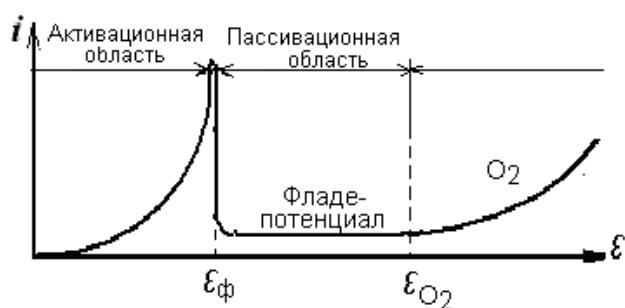
**Рис.4.** Характерный вид анодной поляризационной кривой «плотность тока – напряжение», соответствующей переходу металла из пассивного состояния и началу активного восстановления кислорода
