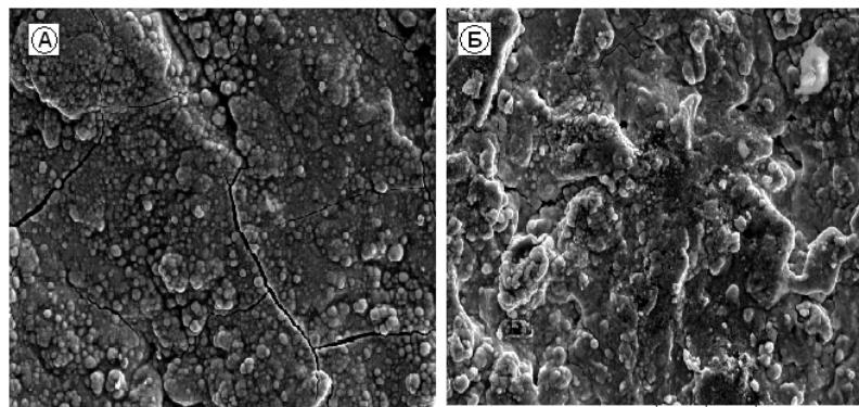
**Рис. 1.** Морфология каталитически активной поверхности металлических Ni-Re-B покрытий: А – исходное покрытие; В – покрытие после выщелачивания
