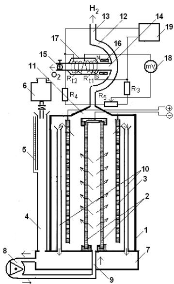
**Рис. 8.** Бездиафрагменный электрореактор с системой автоматического регулирования магнитодинамической очистки электролизного водорода [19]. Обозначения по тексту
