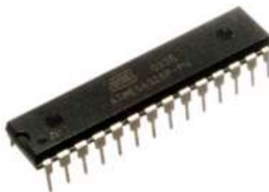
Fig. 2. Microcontrolerul Atmel Atmega 168
