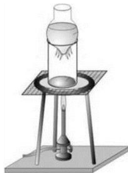
Fig. 18. Instalație pentru purificare prin sublimare.
