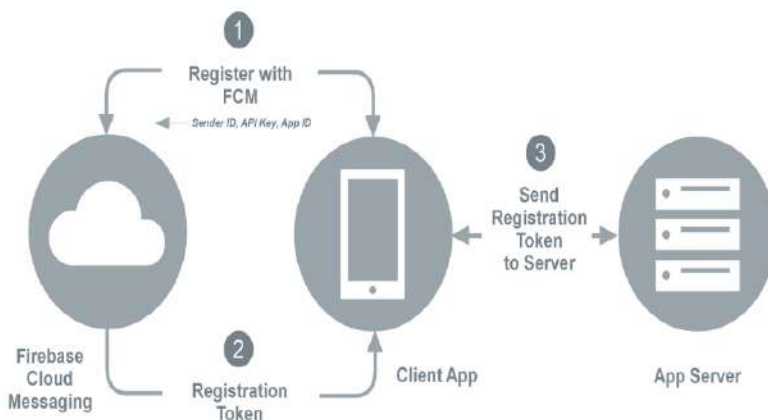
Рис. 1. Схема генерации токенов на устройстве Android
