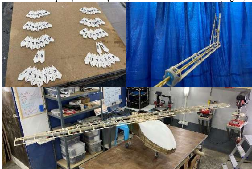
Fig. 2. Piese componente ale suprafețelor de control; structura internă a stabilizatorului vertical stâng; structura internă a celor trei module ale aripii, instalate provizoriu pe fuzelaj
