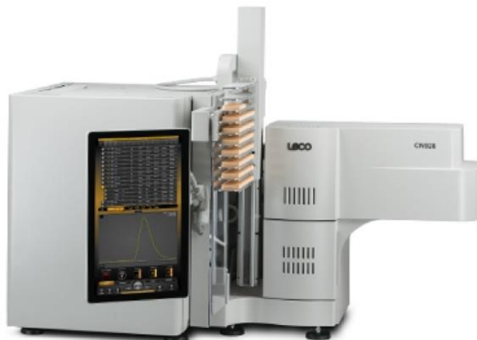
Fig. 3.8 Macro Analizator TruMac CNS pentru determinare simultană a conținutului de carbon, azot și sulf în probe solide.
