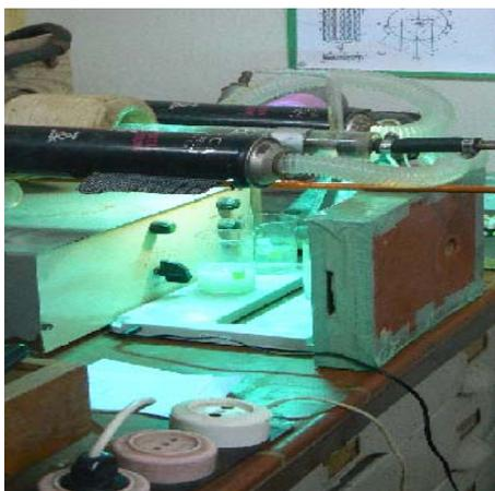
Рис.1. Общий вид лабораторной установки для изучения фотокаталитических процессов.
