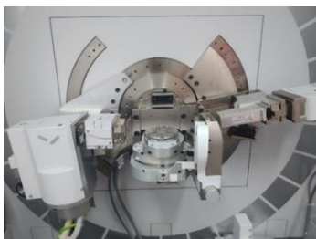
Fig.1. Goniometrul Difractometrului Empyrean (Malvern PANalytical)
