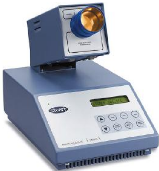
Fig. 3. Aparat pentru determinarea punctului de topire: a - capilar: b - modul de fixare a capilarului pe termometru: c - aspectul general al aparatului Stuart.
