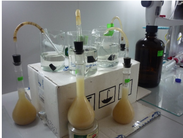
Fig. 1. Instalația experimentală de laborator pentru cercetarea proceselor biochimice de fermentare
