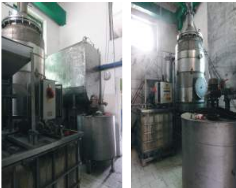
Фото 3. Узлы пилотного реактора и технологического оборудования для биохимической очистки сточных вод производства фирмы BTSCo
