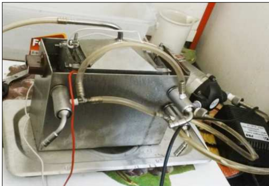
Рис. 5. Внешний вид пилотного водородного электролизера на базе 3D-электродов.
