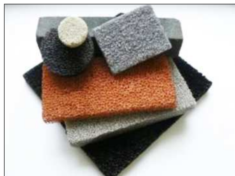
Рис. 1. Внешний вид пенометаллов (А) и их ячеистая структура (Б)
