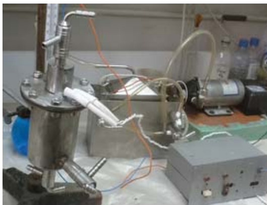
Рис. 2. Общий вид лабораторного электрохимического реактора генерирования водорода с целью его дозирования в биореактор для увеличения выхода биометана
